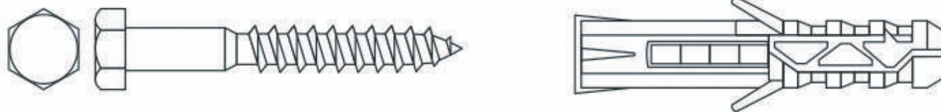
Рисунок 7.4.1 – Шуруп с шестигранной головкой «Глухарь» с дюбелем.
