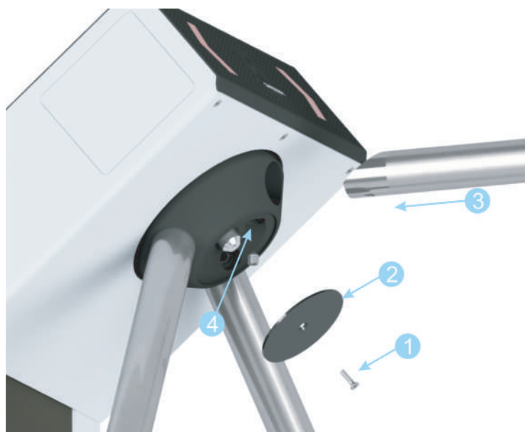
Рисунок 7.5.1 – Установка стандартной преграждающей планки.
